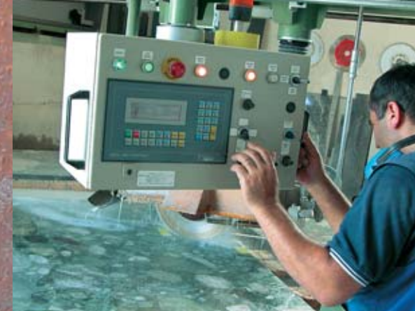
Kompjuterska freza seče kamene ploče milimetarski precizno.
