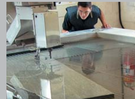
CNC mašina seče kamen pod pritiskom-vode od 4130 bara na najsitnije oblike.
