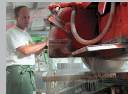
Freza reže sirovu ploču na fine oblike.
